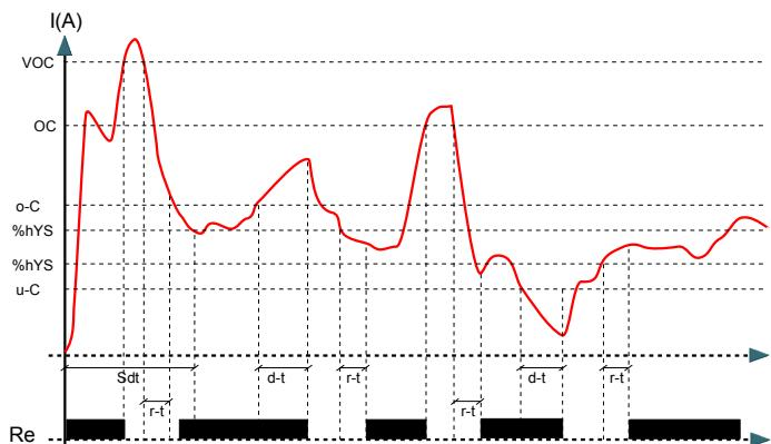
**Sd-t** : Başlangıç gecikme zamanıdır (start delay time). 0 ile 60 sn arasında ayarlanabilir. Akım ilk kez sıfır amperden yükselmeye başladığında (motorların yada sistemin ilk kalkış süresinde) cihazın gereksiz açma yapmasını önlemek için kullanılır. Bu süre içinde çekilen akım değeri, aşırı akım set değerini geçse bile açma gerçekleşmez. Eğer bu değer "000" ("oFF") seçilirse sadece  $d-t$  zamanını sayar ve açma gerçekleşir.
